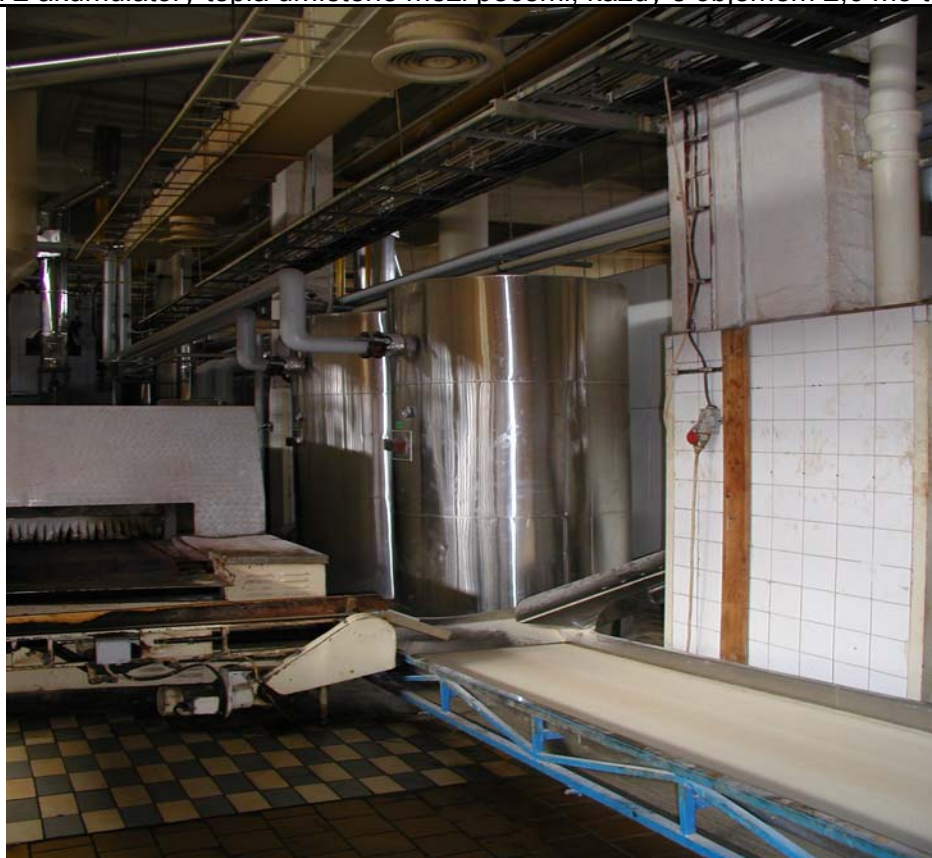
Parní vyvíječe umístěné v horní části pece
