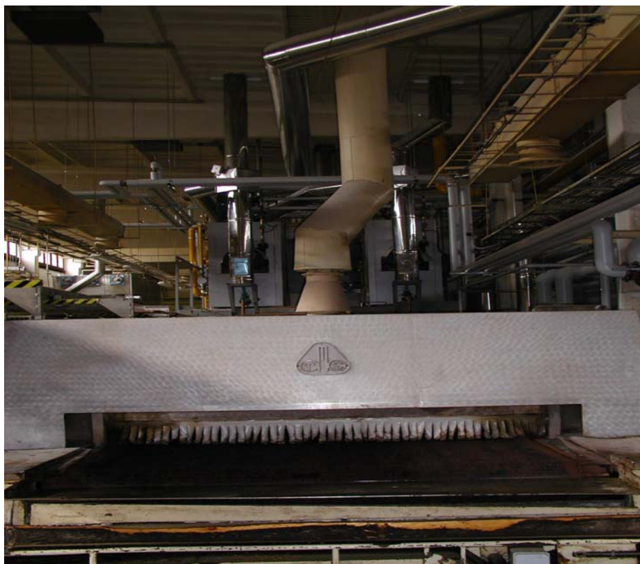
Parní vyvíječe umístěné v horní části pece
