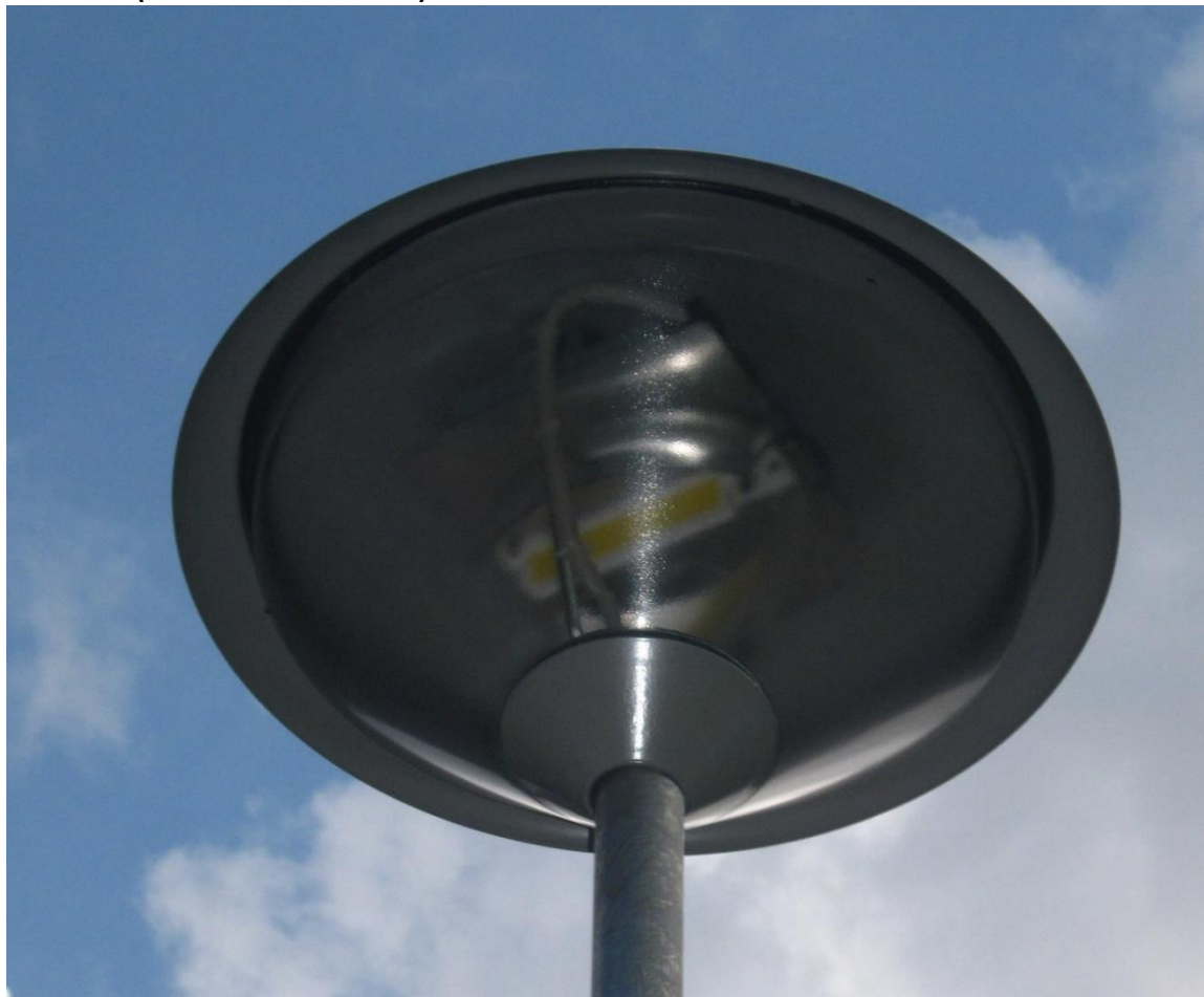
Obrázek 13 Parkové svítidlo s LED modulem opatřeným optickým systémem s integrovaným chladičem (foto: Theodor Terrich)
