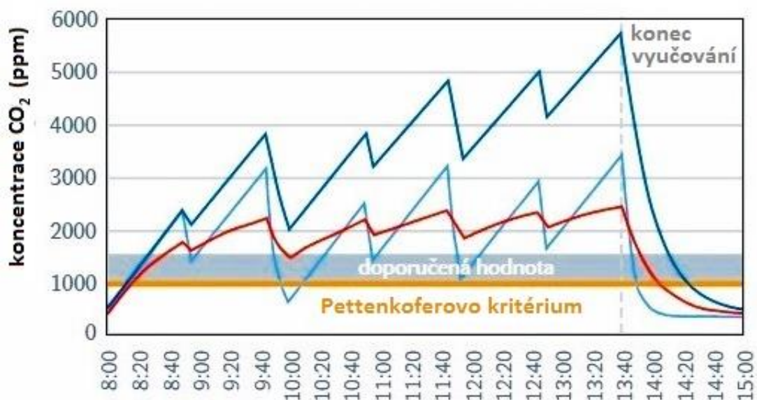
Obrázek 31 Simulace variant větrání léto-zima, 28 žáků, věk 10 let
