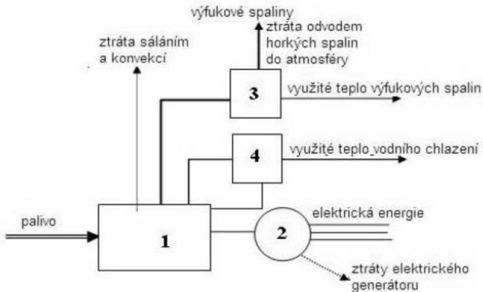
Obr. 10 Toky energie u kogenerační jednotky se spalovacím motorem
