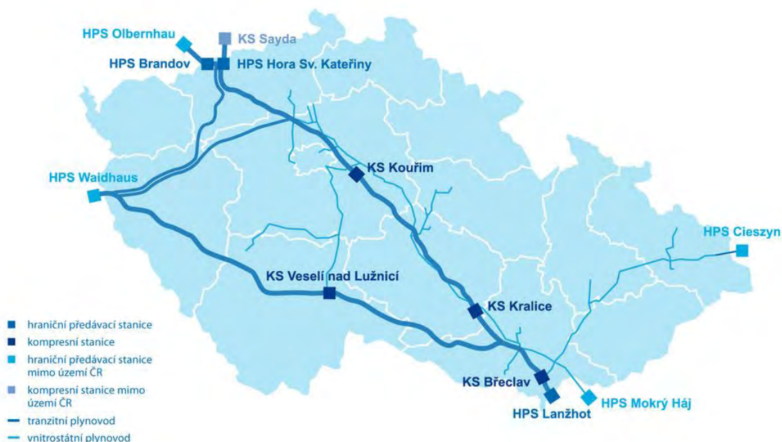
Obrázek 1.6: Přepravní soustava zemního plynu v ČR (systém NET4GAS)
