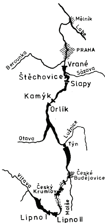
Obr. 1.11: Schéma Vltavské kaskády vodních elektráren [2]
