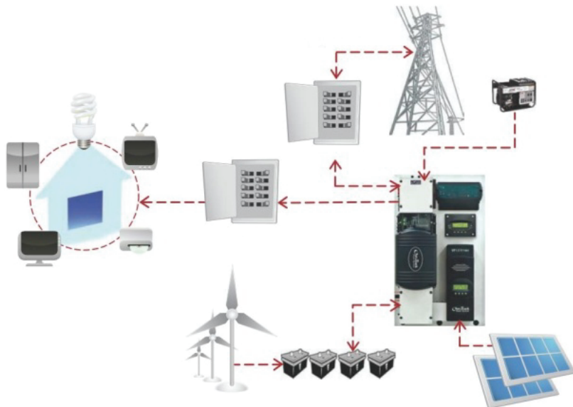
Obr. 3.15: Hybridní fotovoltaický systém [11]
