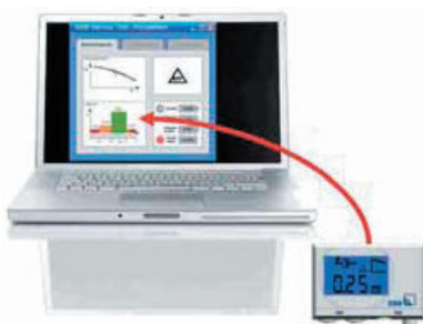
Obr. 4 –Připojení snímače tlaku s počítačem
