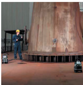
Obr. 2 – Bezdrátové hlídání hranic oblasti – až 25 přístrojů Dräger X-zone 5000 v sestavě
