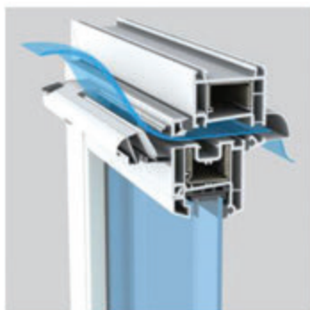
Obr. 2 – Schéma použití okenní štěrby EMF 22
