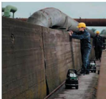
Obr. 3 – Sledování prostorů Vložené osobní plynové multidetektory X-am 5x00 měří koncentrace plynů
