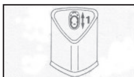
Obr. 4 – Pojist'ovací tlačítko akumulátoru (1)
