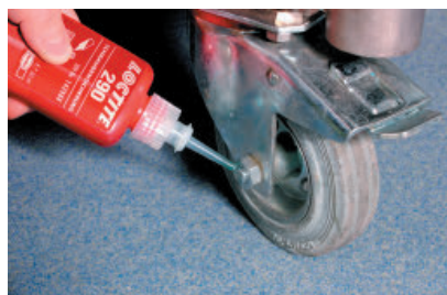
Obr. 3 – Aplikace anaerobního produktu k zajišťování závitů Loctite 290
