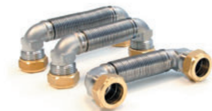
Obr. 8 – Propoj zakončený šroubením se svěrným kroužkem pro napojení na měděné rozvody
