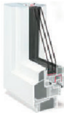
Obr. 2 – 4 komory stavební hloubka 120 mm U_f=0,71
