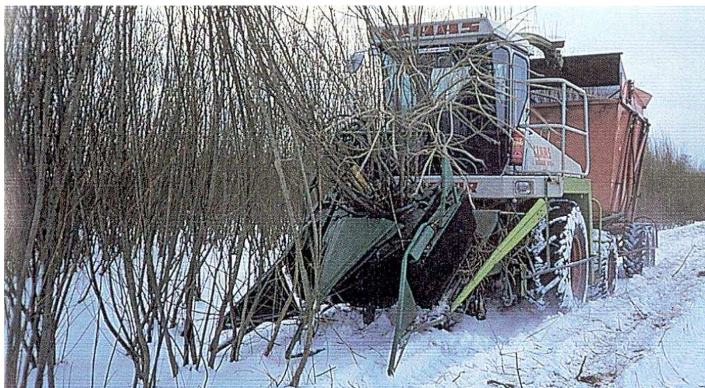
Dělená sklizeň dřevin z plantáží – upravená sklízecí rezačka Jaguár
