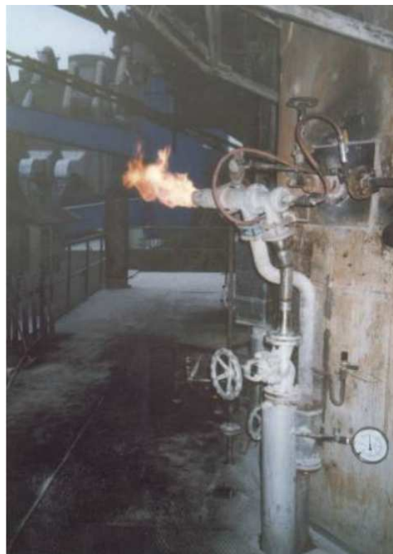
Osazení vápenkářské šachtové pece hořákem na směsné palivo a seřizování ostrosti plamene hořáku na směsné palivo osazeného na šachtové peci
