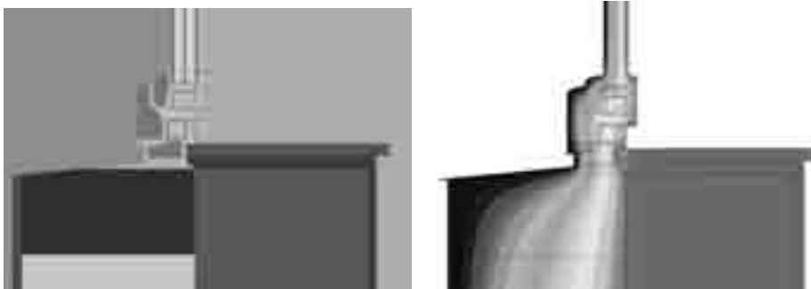
Abbildung 11 und 12: Model (links) und Isothermenkarte (rechts) der Einbausituation unten
