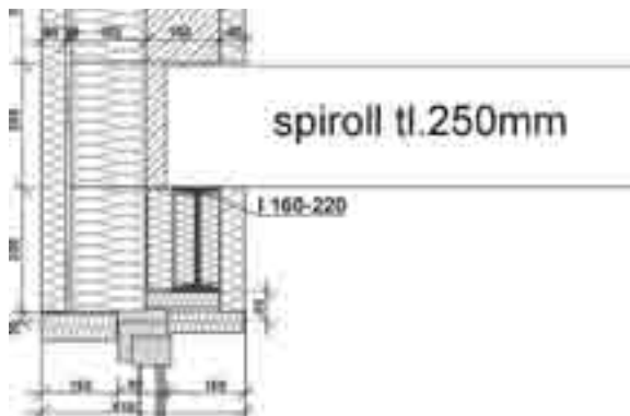
Obr. 3 Důležitý detail napojení okna, stěny a stropu
