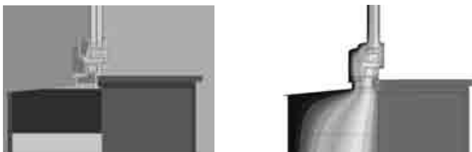
Obr. 13, 14: Model (vlevo) a izotermická mapa (vpravo) montážní situace
