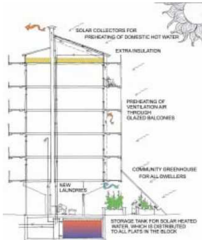
Obrázek 21: Schéma opatření vedoucí ke snížení energetické náročnosti budovy o 7.NP
