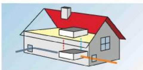
Obrázek 51: Tepelné čerpadlo vzduch/voda, ochlazuje se vzduch odváděný větracím systémem.
