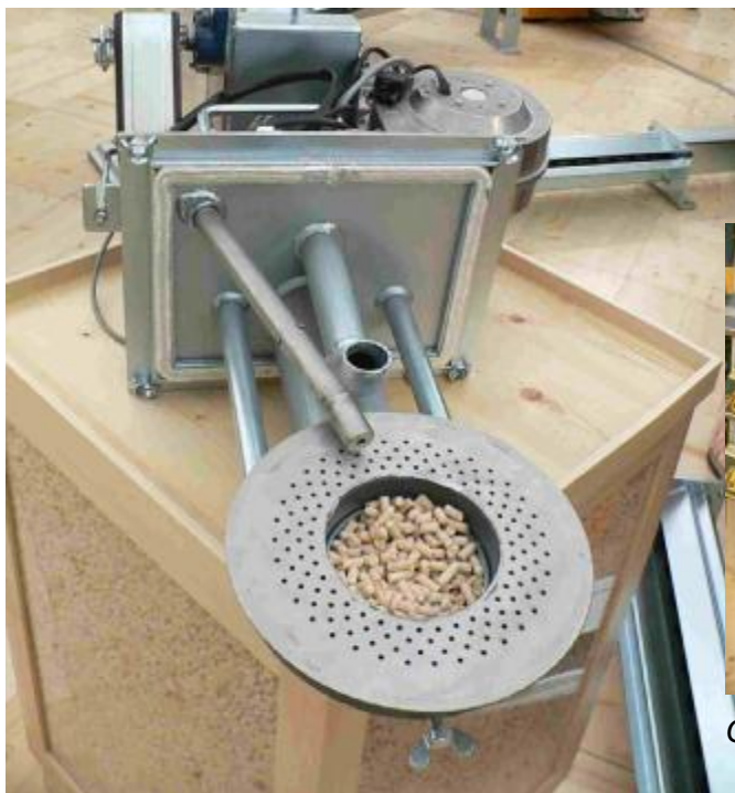
Obrázek 44: Hořák kotle na peletky ( lze vmontovat i do starších kotlů na jiné palivo).
