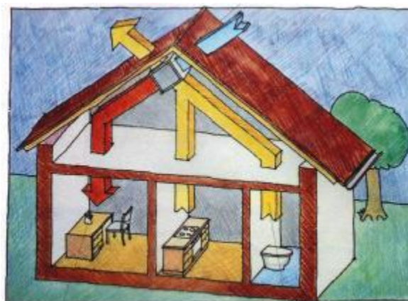
Obrázek 25: Schéma větrání s rekuperací tepla.
