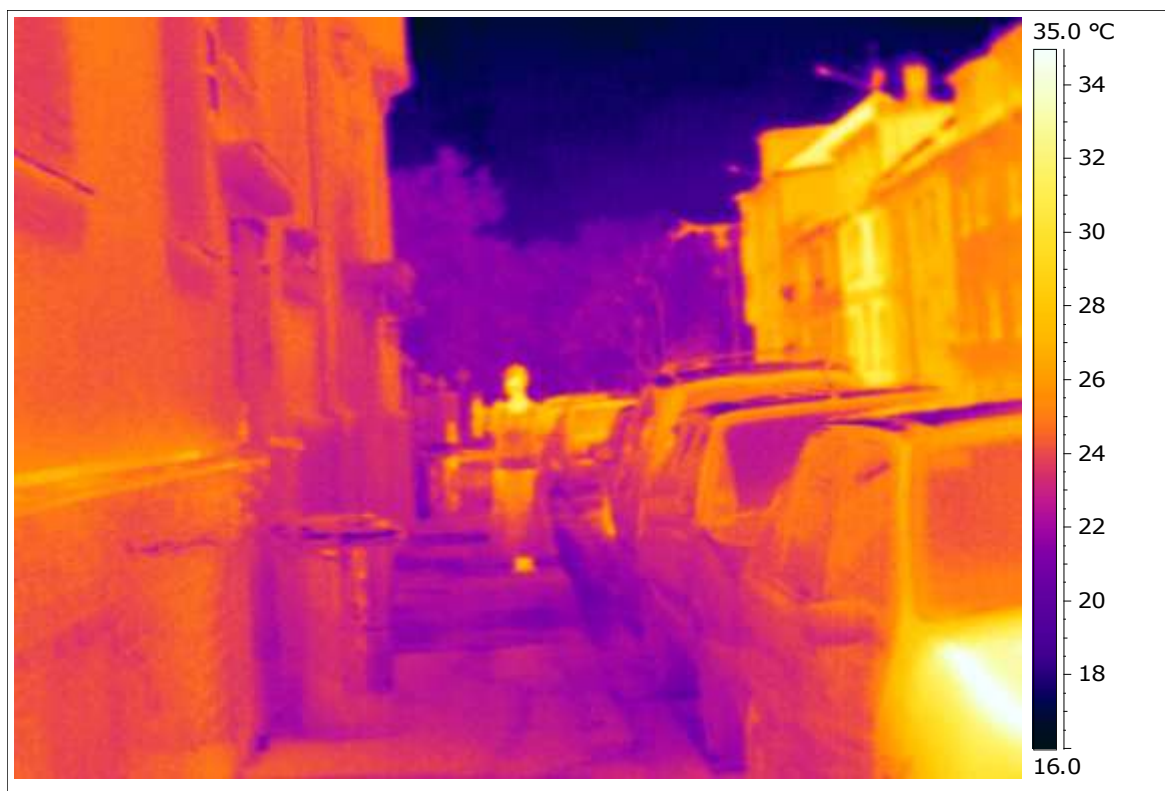
Termovizní snímek již celé postavy ze vzdálenosti cca 10 m. Velikost jednoho zobrazovaného bodu 13,86 mm.
