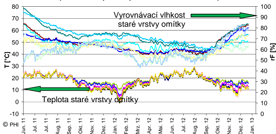
Obrázek 6: Teplota a vyrovnávací vlhkost ve staré vrstvě omítky pod izolací
