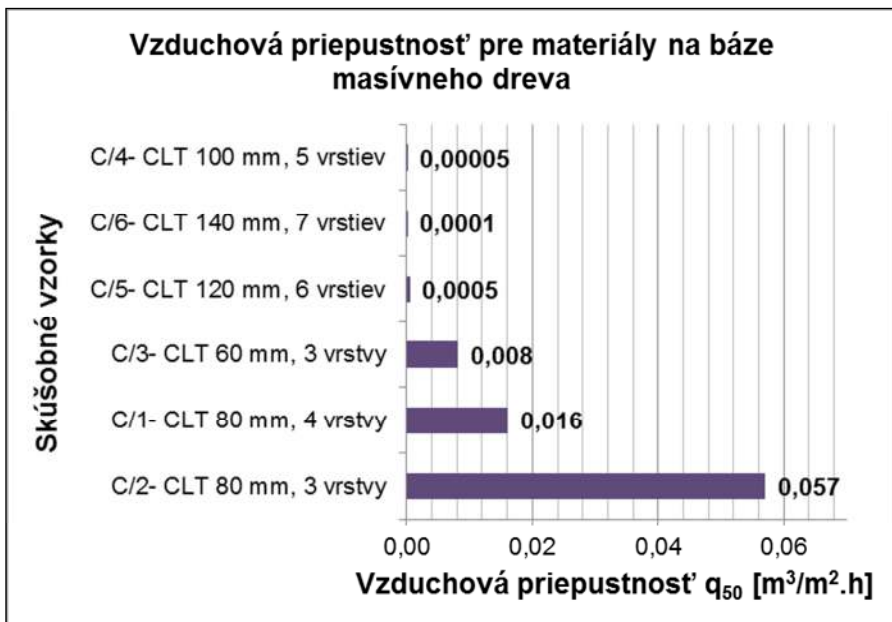
Obr. 6 a) Vzduchová priepustnosť konštrukčných materiálov na báze masívneho dreva CLT
