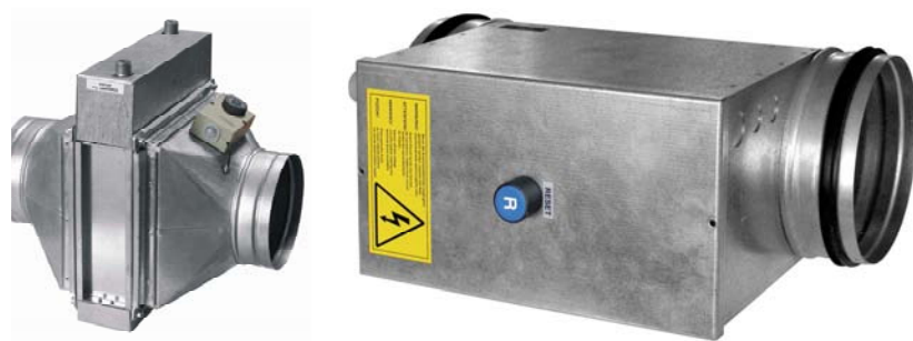
Obr. Nízkoteplotní teplovodní nebo elektrický ohřívač přiváděného vzduchu umožňuje efektivní spojení větrání a teplovzdušného vytápění. Odpadá zde potřeba dalších rozvodů a klasického otopného systému při stejném, ne-li vyšším komfortu.
