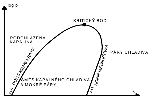
Obr. 4.4 Stavy chladiva v diagramu log p-h
