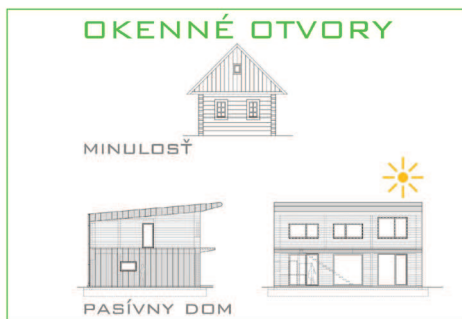
Obr. 1 Okná v minulosti boli minimalizované. V súčasnosti sa v pasívnom dome využívajú slnečné zisky, okná otočená na juh sú dostatočne veľké, ostatné sú minimalizované.
