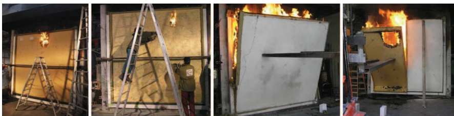
Obr. 2 Zkušební vzorky v době ukončení požární zkoušky (zleva): Skladby 1a, 1b. Skladby 2a, 2b. Slaměná stěna - skladba 3. Skladba 4a, 4b.
