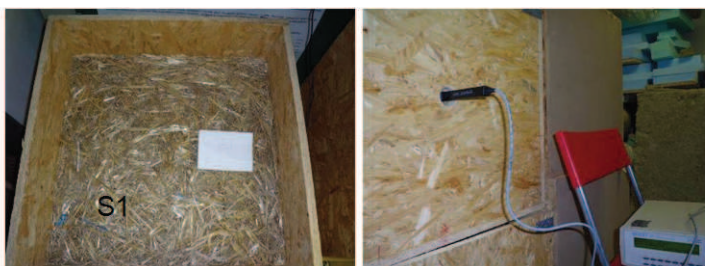
Obr. 6 Vlevo – vzorek z nestlačené slámy; Vpravo - přístroj ISOMET 2104 a měření jehlovou sondou
