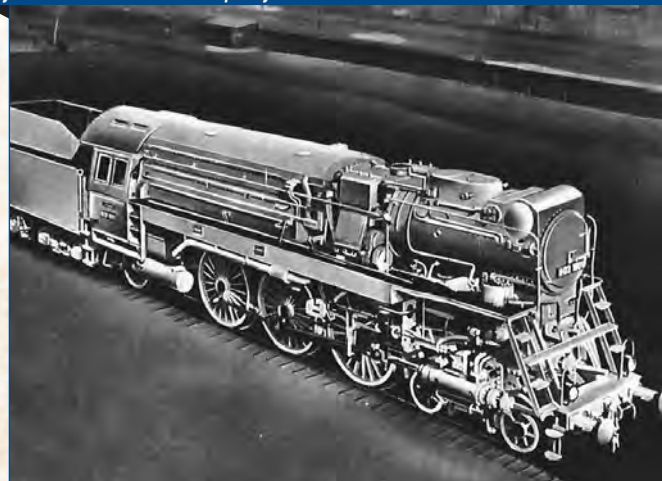
Vysokotlaká lokomotiva s úsporným kotlem na tlak 120 atmosfér
