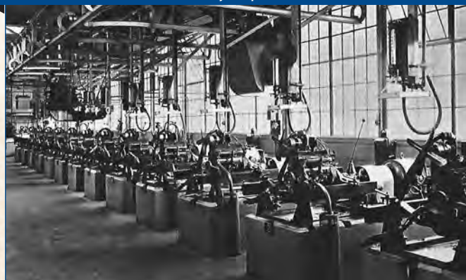
Brzdící stanice motorů. Nad motory jsou nádržky s palivem, jehož spotřebu bylo možné měřit. Elektrické brzdící zařízení je na prodloužené ose motorů u oken
