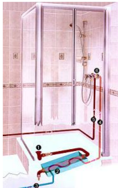
Obr.8 Sprchový rekuperační výměník odpadní vody. Jeho použitím lze ušetřit až 40% tepelné energie. Jednoduše se připojí na odtok pod sprchovým koutem anebo vanou. Teplo nám pak zbytečně neodtéká kanálem, ale využívá se znovu na předhřev vody.
