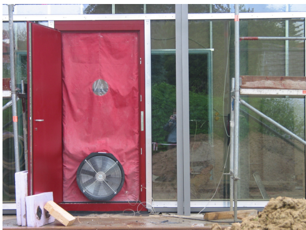
Obr.7 Měření neprůvzdušnosti je nezbytnou součástí realizace a zajištění kvality pasivních domů. Po dokončení vzduchotěsnicí vrstvy je nutné provést měření, aby odhalené netěsnosti mohly být včas opraveny.
