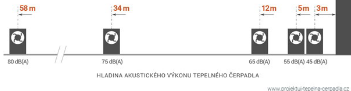
Obrázek 13: Hodnoty akustického výkonu tepelného čerpadla v závislosti na vzdálenosti od budovy, Zdroj: GT Energy
