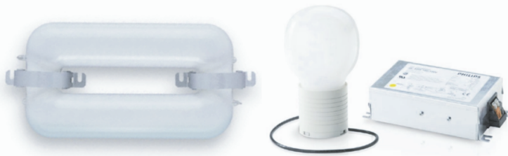
Obr. 4.4: Indukční výbojka Osram Endura (cívka po obvodu) a Philips QL (cívka uvnitř baňky)
