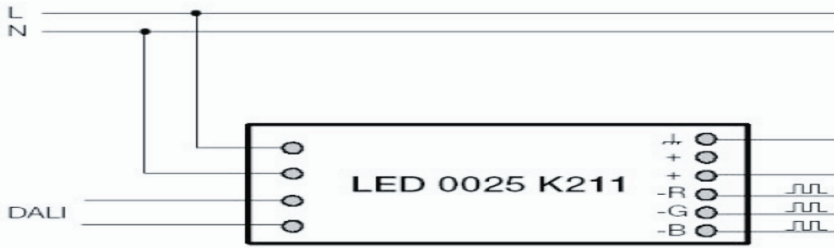
Obr. 11.13: Ukázka regulace tří LED modulů pomocí DALI standardu
