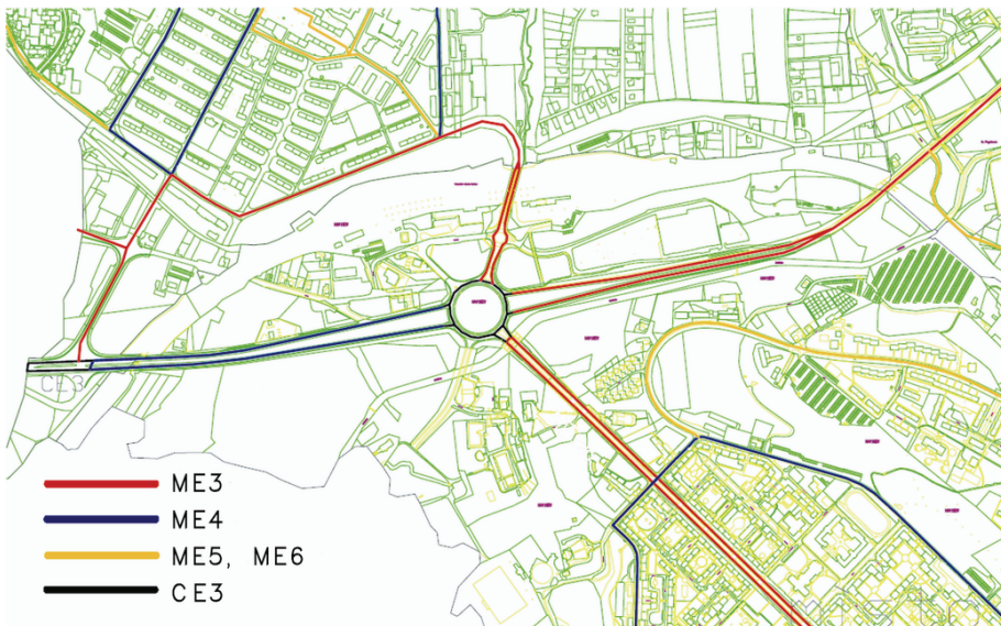
Obr. 7.6: Příklad zatřídění VO ve městě Havířově
