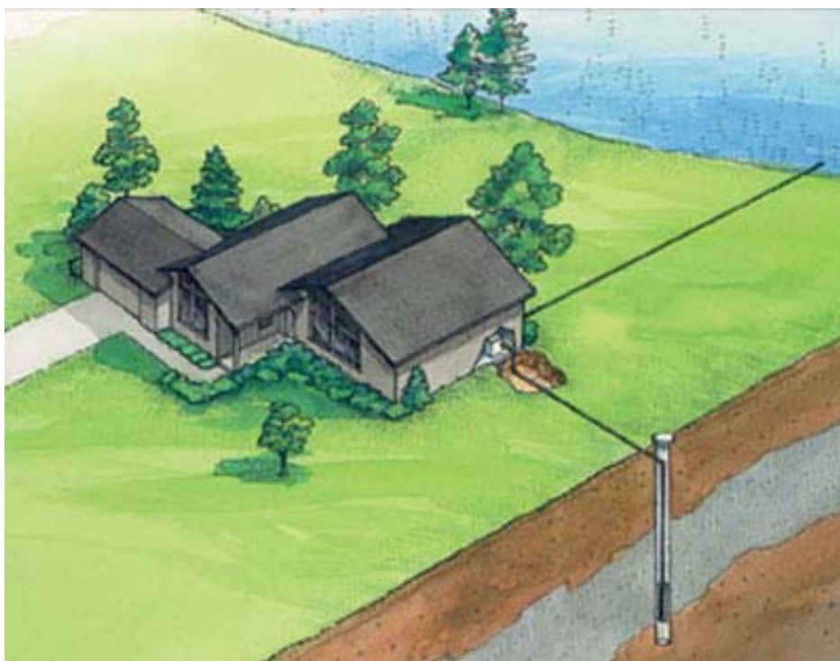
Obr. 3. Příklad čerpacího vrtu na vodu pro tepelné čerpadlo, utrácení vody do vodní nádrže
