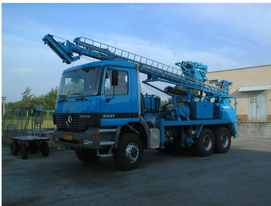
Obr. č. 13. Vrtná souprava typu NORDMEYER vybavená speciální technologií pro realizaci vrtů pro tepelná čerpadla
