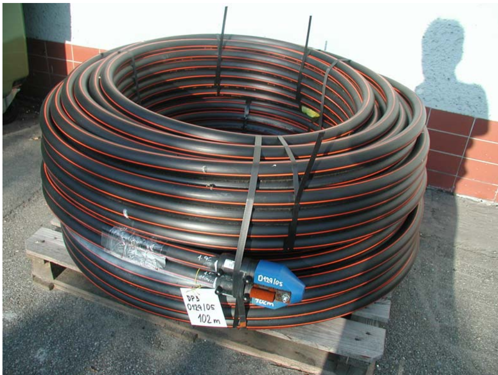
Obr. 16. Speciální spojovací PE-patice (modré barvy) na kotouči PE-trubek (tzv. PE-kolektor), který je zapuštěn do vrtu pro tepelné čerpadlo
