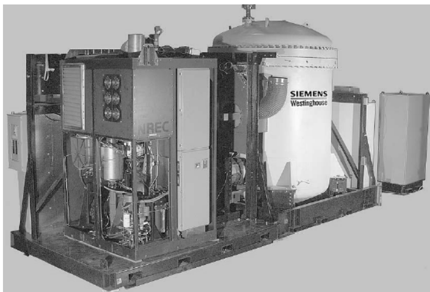
Obrázek 8-3 Jednotka SCE 220 kW SOFC/GT Hybrid Power System. Hybridní systém SOFC se spalovací turbínou, jednotka P_{el} = 220 \text{ kW} fy Siemens Westinghouse, pracovní přetlak 3 bar, elektrická účinnost jednotky \eta_{el} = 57\% .
