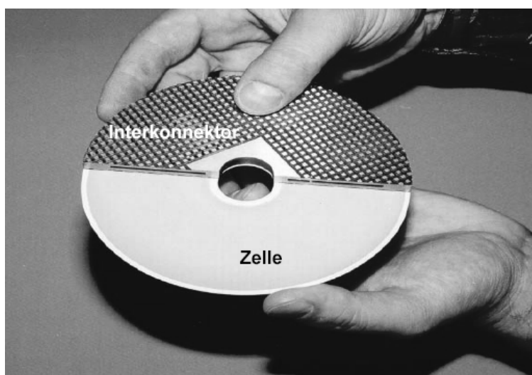
Obrázek 6-12 Bipolární deska dvouvrstvá (interkonektor) a článek (zelle) systému HEXIS.
