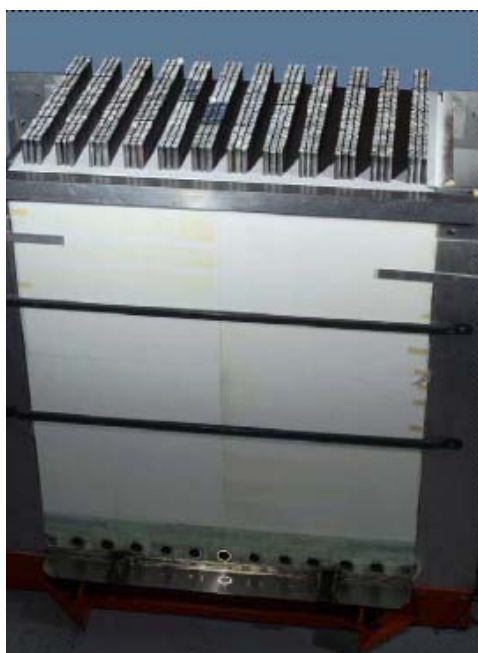
Obrázek 6-10 Jednotka SOFC 100 kW (obsahuje 1152 jednotlivých článků).
