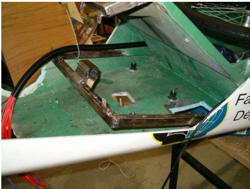
Obrázek 3-25: Pohled do strojové části prototypu HIX před dokončením nosné konstrukce a vložením vodíkového okruhu s palivovým článkem.
