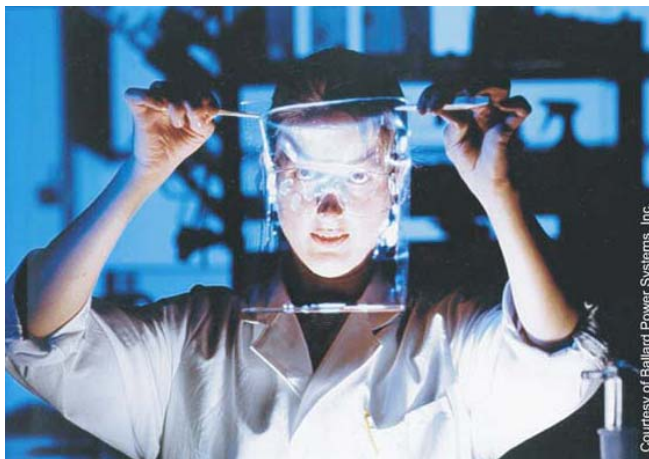
Obrázek 2-14: Tuhá elektrolytická membrána pro palivové články typu PEM kanadské firmy Ballard.
