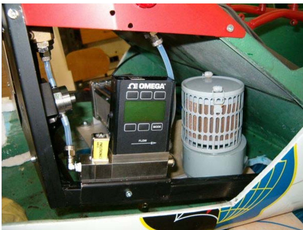
Obrázek 3-26: Pohled do strojové části prototypu HIX po vložení vodíkového okruhu s palivovým článkem.
