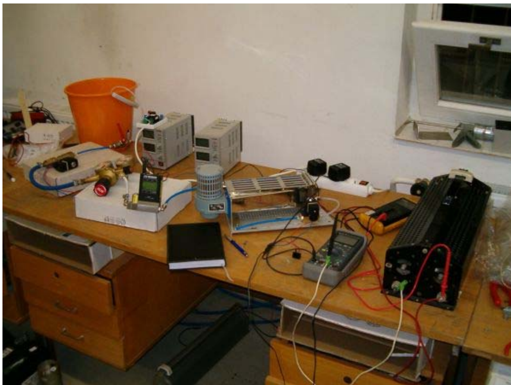
Obrázek 3-24: Jeden z testů palivového článku FYD-200 - účinnost palivového článku v závislosti na tlaku vodíkového paliva.
