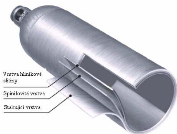
Obrázek 1-18: Konstrukce láhve Typu 3.
