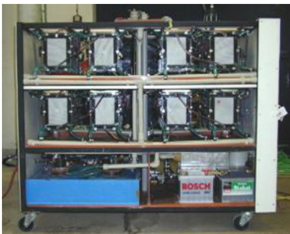
OBR. 3.21 KOGENERACNÍ JEDNOTKA S PALIVOVÝMI ČLÁNKY O VÝKONU 4 KW
