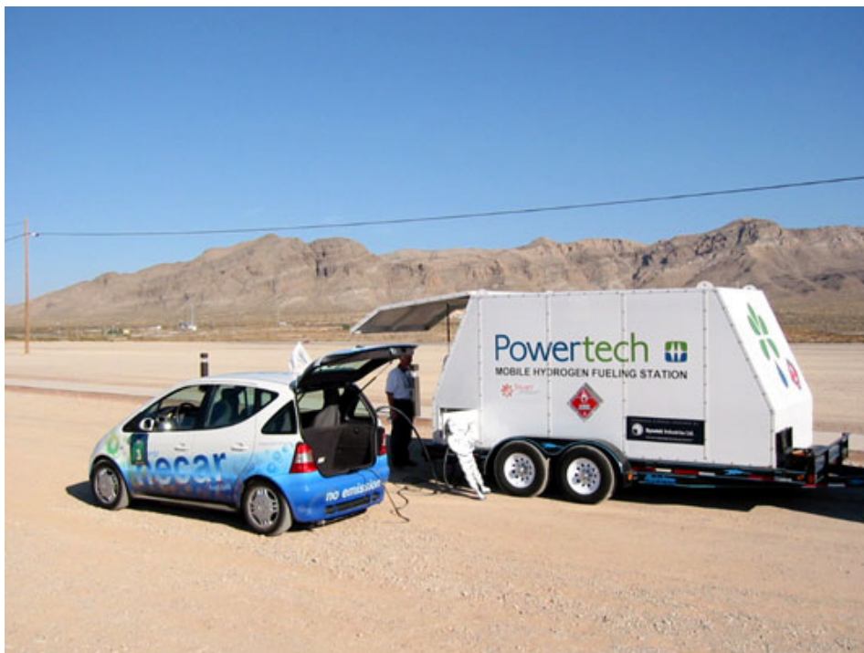
Obrázek 61: Mobilní čerpací stanice kanadské firmy Dynetek
