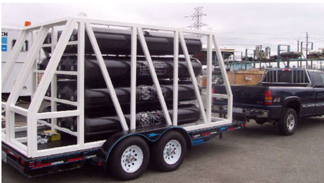
Obrázek 62: Mobilní čerpací stanice kanadské firmy Dynetek
