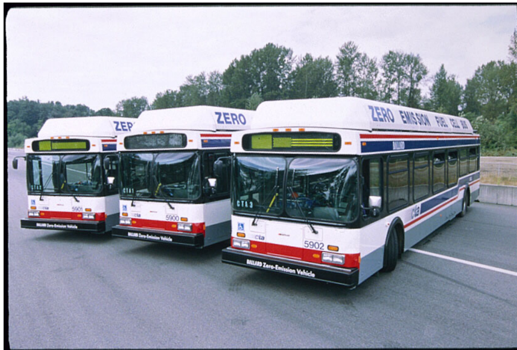
Obrázek 37: První autobusy s palivovými články, používané dva roky v městské hromadné dopravě v Chicagu a Vancouveru
