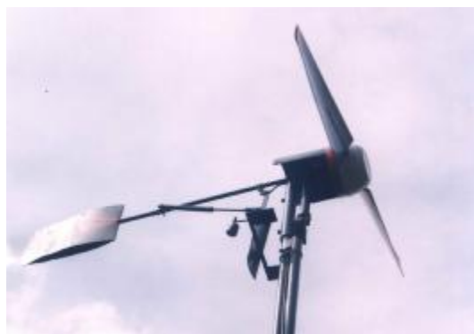
Obrázek 51: Malá větrná elektrárna svépomocné výroby
