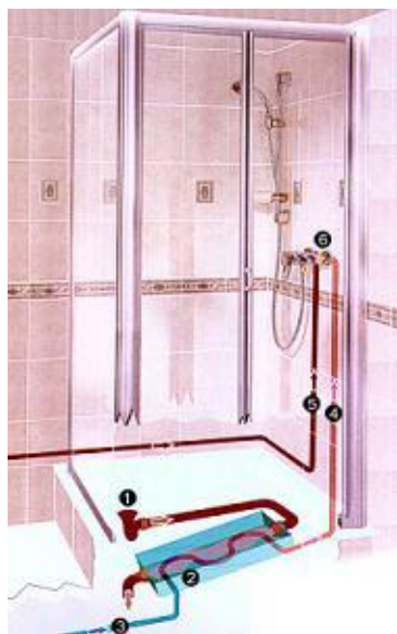
Obrázek 26: jednoduchý rekuperační výměník do sprchy
