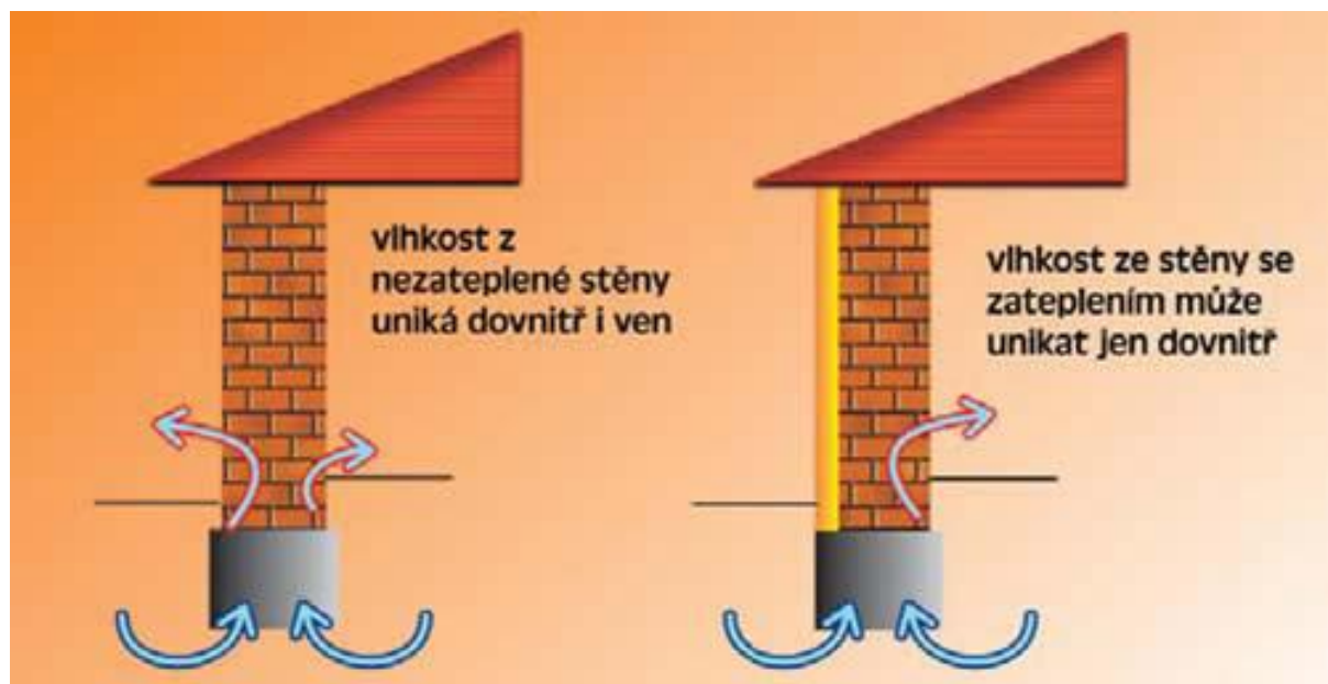
Obrázek 18: Vlhkost při zateplování
