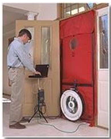
Obrázek 25: Test těsnosti budovy (Blower-Door Test)
