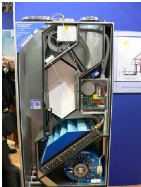
Obrázek 33: Centrální větrací jednotka s rekuperací tepla
