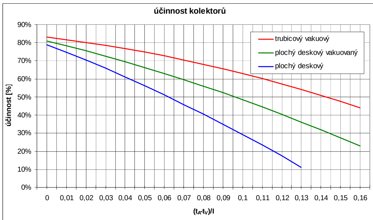
Obrázek 38: Srovnání účinnosti různých typů kolektorů.
