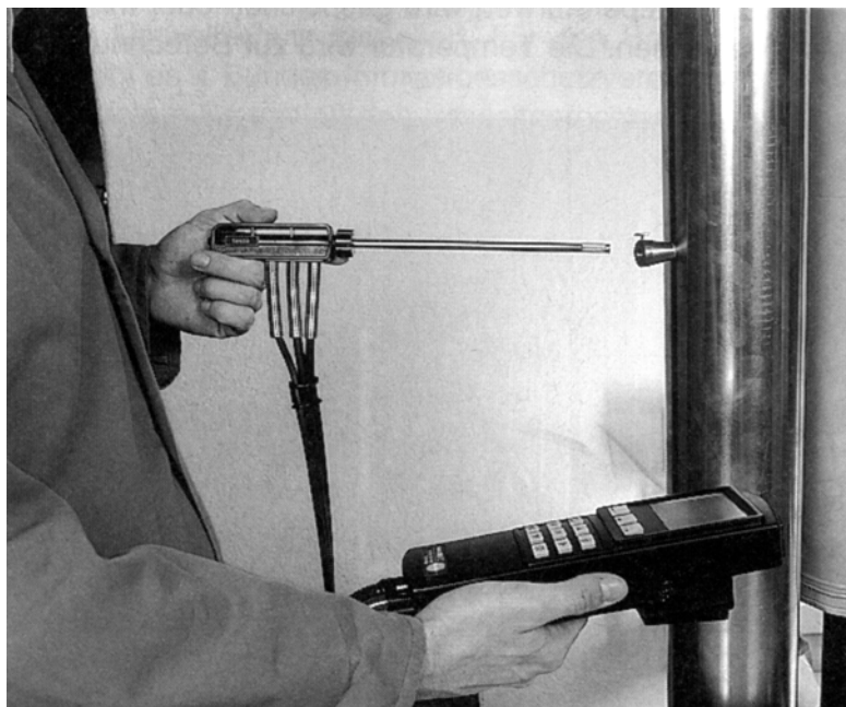
Obrázek 16 – Způsob vložení sondy do měřicího otvoru na kouřovodu
