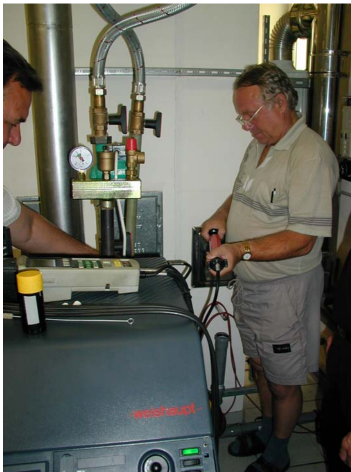
Obrázek 21 – Měření sazového čísla u kotle na lehký topný olej
