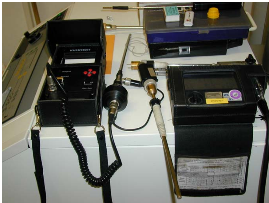
Obrázek 15 – Aklimatizace analyzátoru spalin v kotelně před měřením
