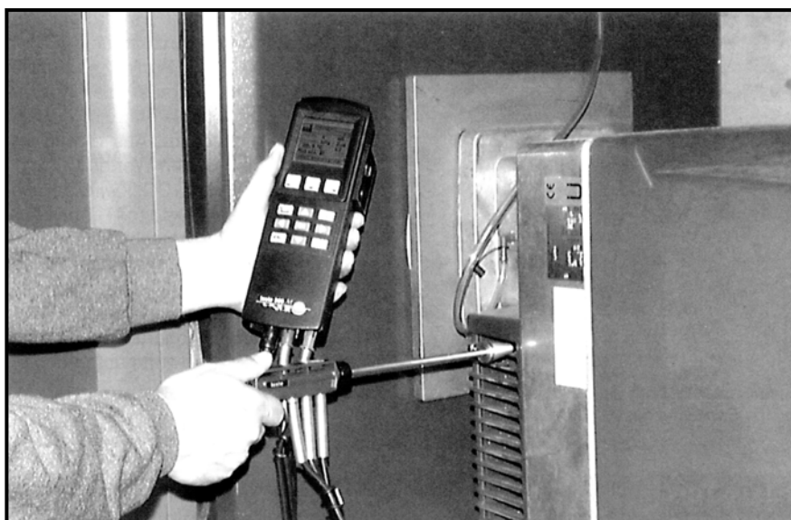
Obrázek 15 – Měření teploty vzduchu přiváděného ke spalování
