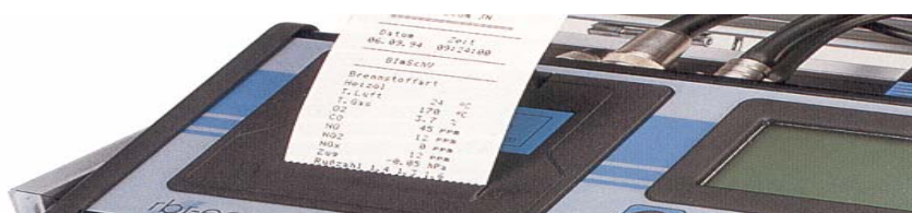
Obrázek 17 – Přenos změřených a vypočtených hodnot tiskárnou na analyzátořu
