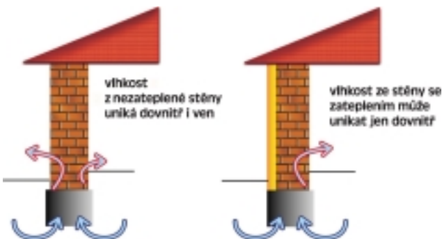
Obrázek 2: Zateplení vlhkého zdiva.
