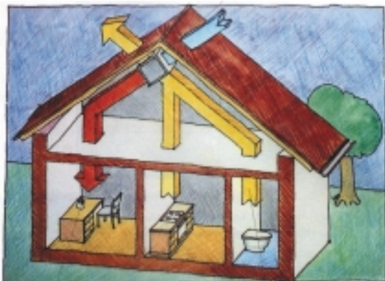
Obrázek 6: Schéma větrání s rekuperací tepla.
