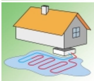
Obrázek 6: Tepelné čerpadlo nemrznoucí kapalina/voda; výměník naplněný nemrznoucí směsí ochlazuje půdu ve vrtu nebo ve výkopu, případně vodu ve vodním toku nebo v rybníku.
