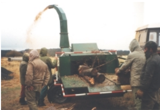
Obrázek 1: Zpracování odpadní biomasy štěpkováním.
