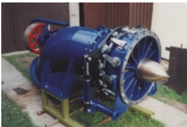
Obrázek 7: Kaplanova turbína. (Zdroj: HYDROHROM.)
