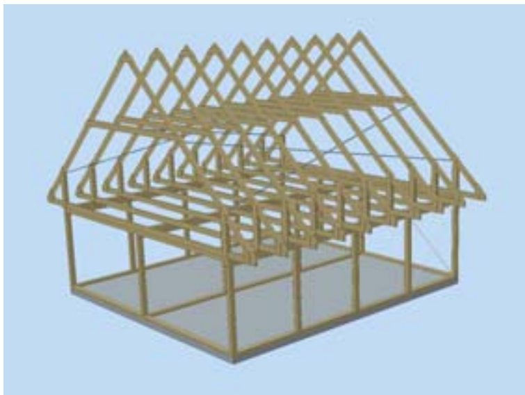
Obr.1 Dřevěný skelet koberovských domů
