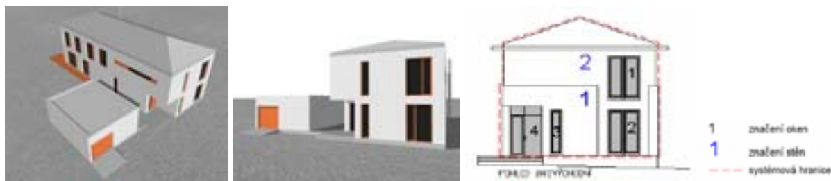
Obr. 1 Optimalizovaný nízkoenergetický RD (nepodsklepený, 2 NP, užitná plocha 266 m 2 , vytápěný objem 722 m 3 ). Vlevo vizualizace architektonického návrhu, vpravo schéma výpočtového modelu.
