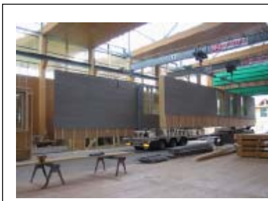
Abb 15-17: Produktion und Transport der vorgefertigten Fassadenelemente (Juli 2006)
