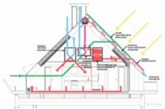
Obr. 3.2 – Řez + Schéma vytápění a ohřevu TV
