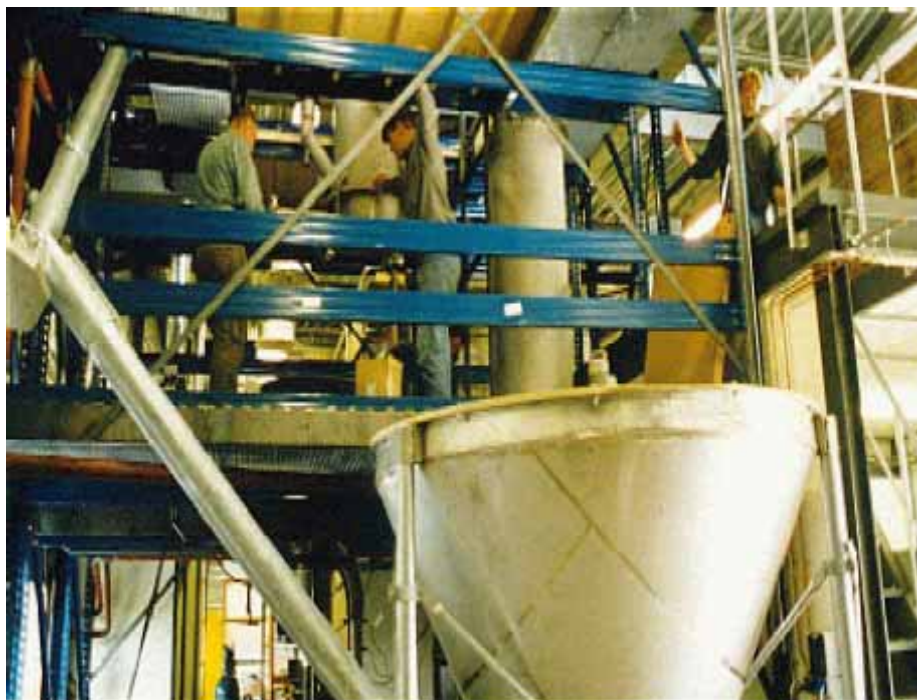
Obrázek 10: Pilotní pyrolýzní jednotka na biomasu s kapacitou výroby bio-oleje 5t/den firmy BTG
