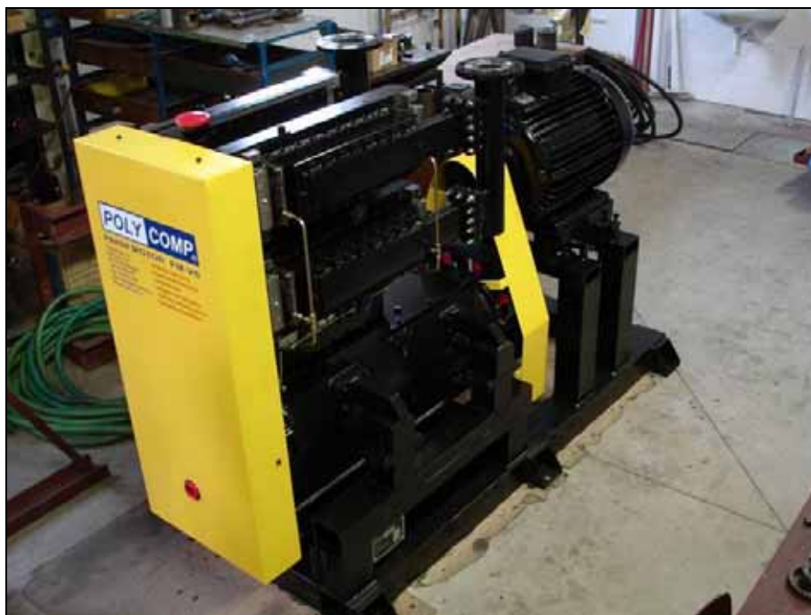
Obrázek 13: Kogenerační jednotka PM-VS s parním strojem firmy Polycomp
