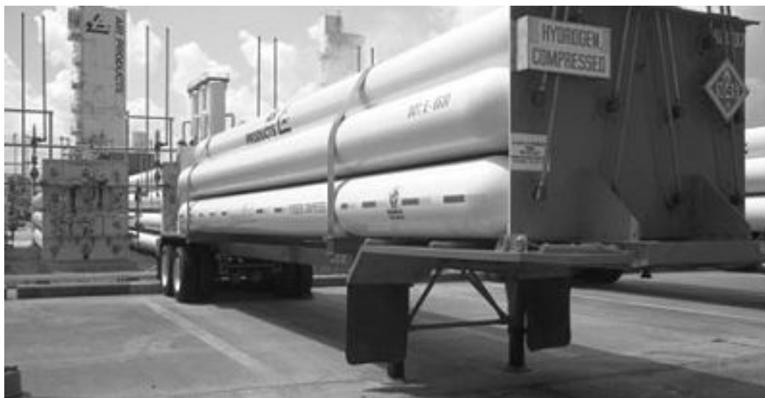
Obrázek 1: Skladování stlačeného plynného vodíku
